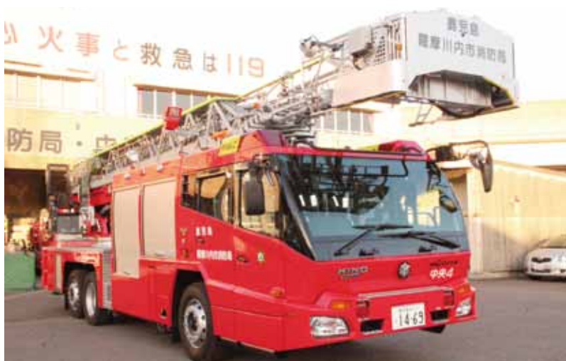
中央消防署 災害対応特殊はしご付消防ポンプ自動車（30m 級）
